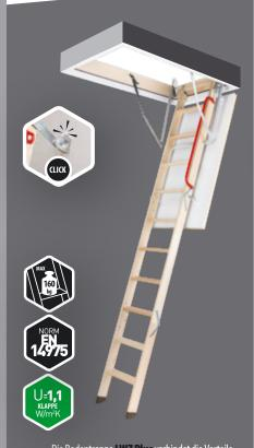
Die Bodentreppe LWZ Plus verbindet die Vorteile der FAKRO-Bodentreppen mit einem Schnellmontage-System. Die dreiteilige Bodentreppe verfügt über einen fest integrierten Stahltragrahmen, der Kasten, Montagewinkel und Abdeckleisten in einem Paket vereint. So kann die Treppe schnell justiert und montiert werden und die Fuge wird automatisch verdeckt.
