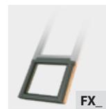
Die Wahl des passenden Eindeckrahmens erfolgt aus dem Sortiment der Standard-Einzeleindeckrahmen: Es wird die Blendrahmenhöhe des oberen Dachfensters mit der Blendrahmenhöhe des unteren FX\_ Fensters addiert und aus dem FAKRO Standardprogramm dann der entsprechend nächsthöchste Eindeckrahmen bestellt. Dieser lässt sich dann ganz einfach an die gemeinsame Höhe anpassen (entsprechende Überlappung der Seitenteile)
